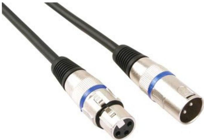
Cavo audio professionale dotato di connettore XLR 3 poli maschio e XLR 3 poli femmina. Colore: nero, lunghezza: 3 metri, conduttore interno: (0,12 mm x 20) x 2, calza: 0,12 mm x 64, diametro esterno: 6,5 mm.
