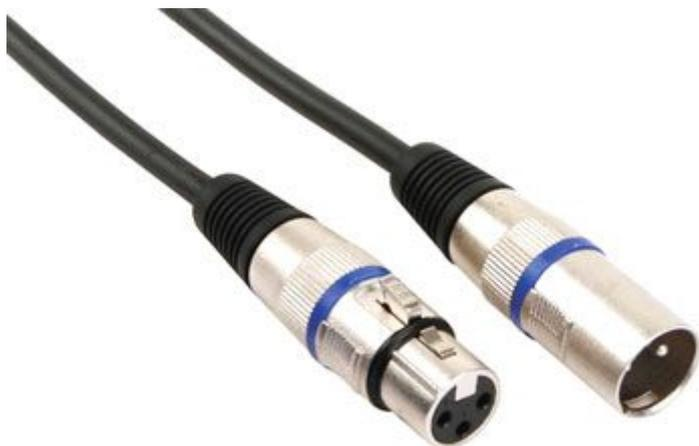
Cavo audio professionale dotato di connettore XLR 3 poli maschio e XLR 3 poli femmina. Colore: nero, lunghezza: 6 metri, conduttore interno: (0,12 mm x 20) x 2, calza: 0,12 mm x 64, diametro esterno: 6,5 mm.
