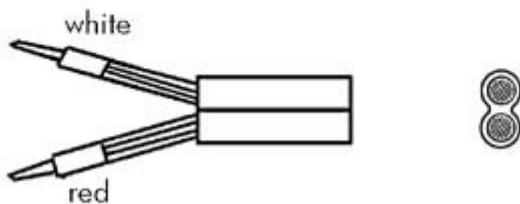
Cavo audio a doppia schermatura 2 x 0,25 mmq, bobina da 100 metri.
