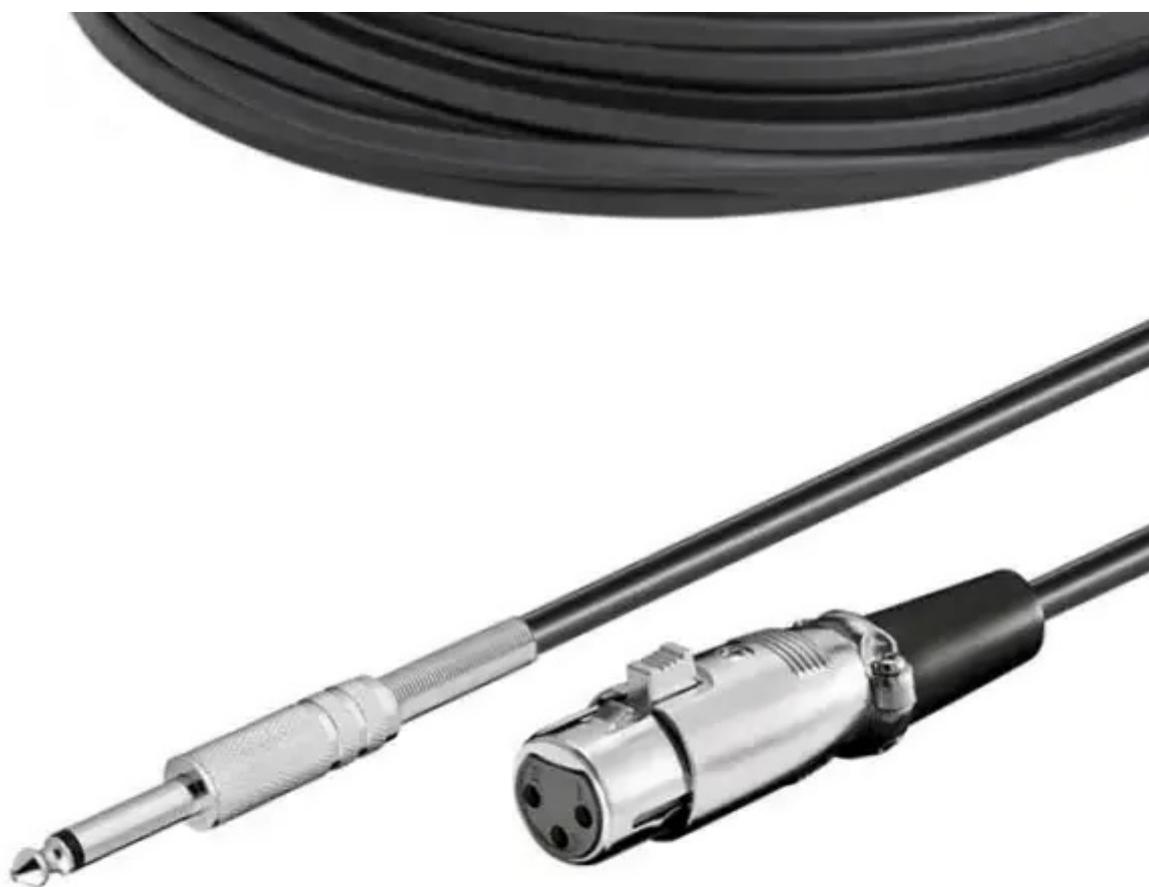
Cavo audio professionale dotato di connettore XLR 3 poli femmina e spina jack mono 6,35 mm. Lunghezza: 6 metri, resistenza di isolamento: 10 Ohm @ 500 V, rigidità dielettrica: 2 kV a 50 Hz, 2 sec., peso: 316 grammi.
