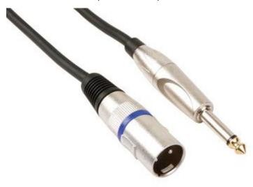
Cavo audio professionale dotato di connettore XLR 3 poli maschio e spina jack mono 6,35 mm. Lunghezza: 6 metri, conduttore interno: (0,12 mm x 20), calza: 0,12 mm x 32, diametro esterno: 6 mm.
