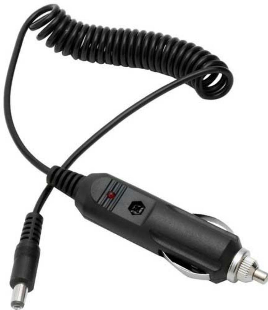
Cavetto spiralato con spinotto per presa accendisigari, fusibile di protezione e plug DC 5,5x2,1 mm compatibile con tutti i tipi di presa accendisigari 12/24 V presenti sui veicoli. Corrente massima in utilizzo continuo: 1 A, lunghezza cavo esteso: circa 1 metro.
