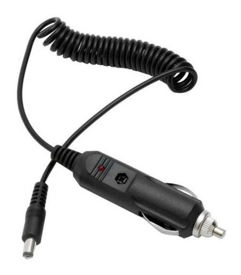
Cavetto spiralato con spinotto per presa accendisigari, fusibile di protezione e plug DC 5,5x2,1 mm compatibile con tutti i tipi di presa accendisigari 12/24 V presenti sui veicoli. Corrente massima in utilizzo continuo: 2 A, lunghezza cavo esteso: circa 1 metro.
