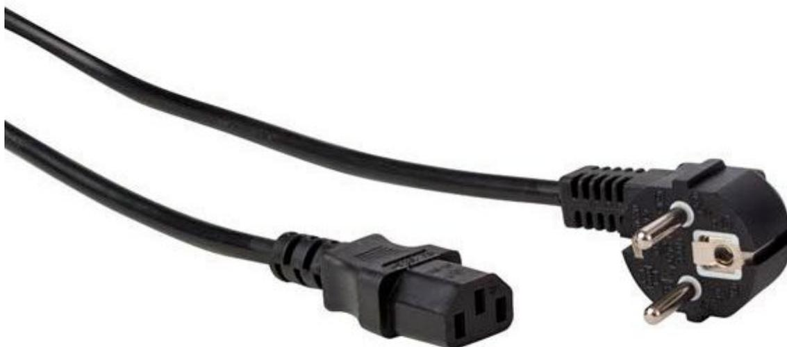
Cavo di alimentazione (H05VV-F 3G1.0mm<sup>2</sup>) 250 Vac con plug IEC C13 in una estremità e CEE 7/7 90° (Schuko) nell'altra. Corrente 10 A, lunghezza 1,5 metri, colore nero.
