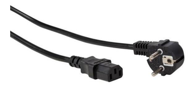
Cavo di alimentazione (H05VV-F 3G1.0mm²) 250 Vac con plug IEC C13 in una estremità e CEE 7/7 90° (Schuko) nell'altra. Corrente 10 A, lunghezza 2 metri, colore nero.
