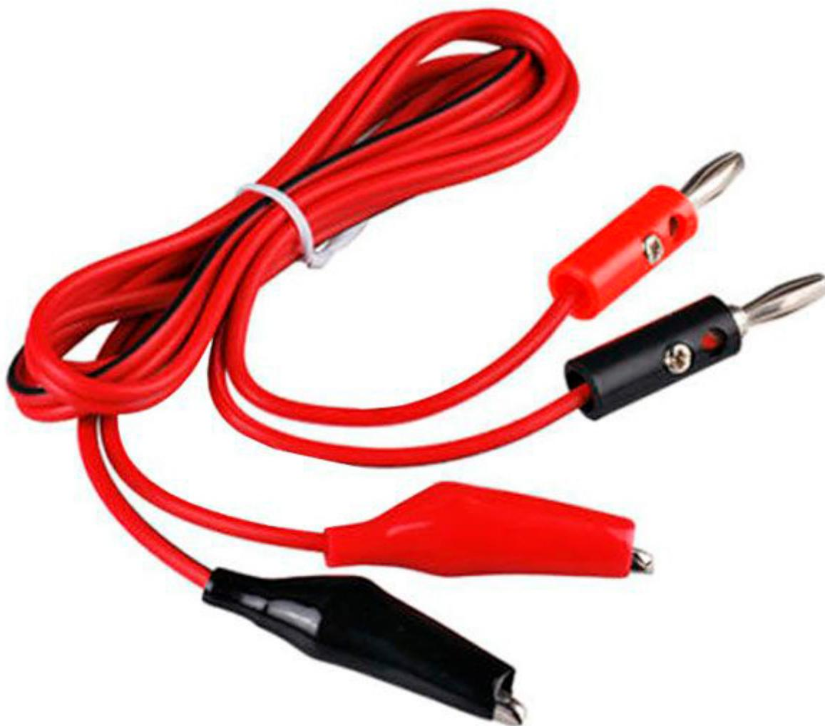
Coppia di cavetti (rosso e nero) dotati di spinotto a banana da 4 mm da un lato e coccodrillo (lungo circa 35 mm) dall'altro. Ciascun spinotto a banana è dotato di una presa per l'innesto di un'altra spina a banana. Particolarmente adatti per alimentatori, oscilloscopi, generatori di funzioni, ecc. Lunghezza totale: circa 1 m.
