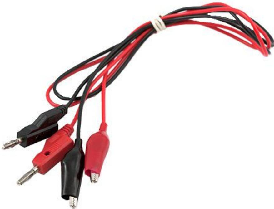
Coppia di cavetti (rosso e nero) dotati di spinotto a banana da un lato e coccodrillo dall'altro. Ciascun spinotto a banana è dotato di una presa posteriore per l'innesto di un'altra spina a banana. Particolarmente adatti per alimentatori, oscilloscopi, generatori di funzioni, ecc. Lunghezza totale: circa 90 cm.
