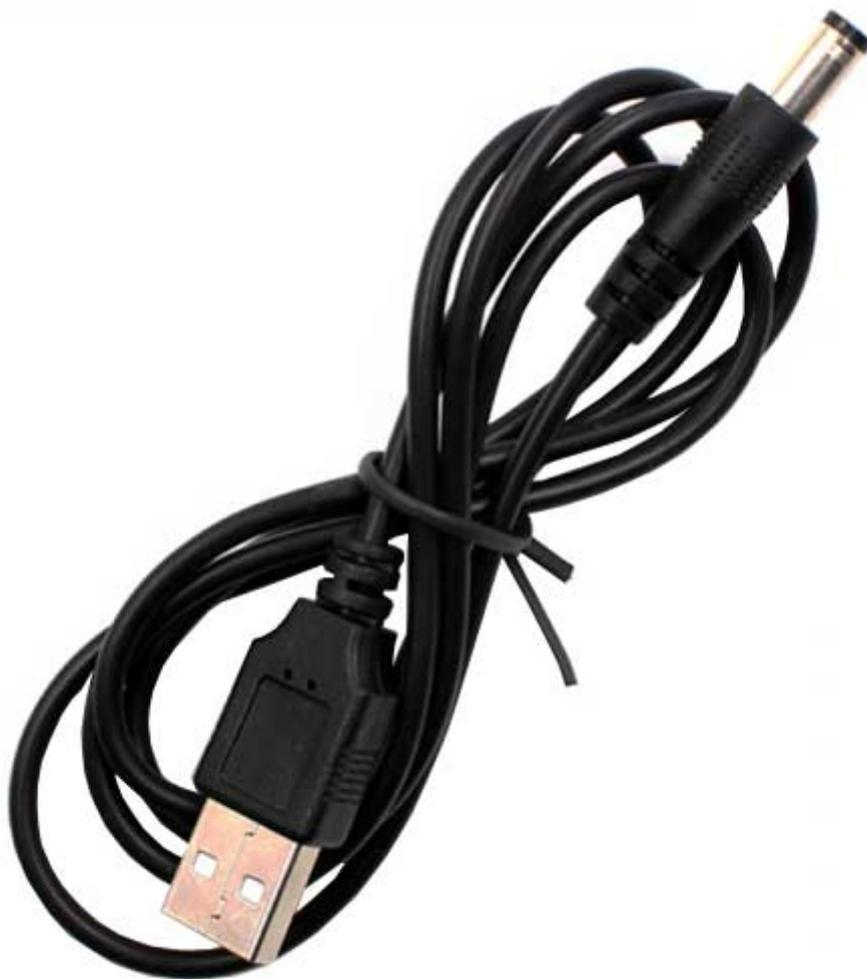
Cavo con convertitore DC/DC step-up integrato in un connettore USB. È in grado di convertire la tensione di 5 VDC in ingresso (connettore USB), in una tensione di uscita a 12 VDC (circa 100 mA) disponibile tramite plug DC (5,5x2,1 mm). Lunghezza totale del cavo: circa 1 metro.
