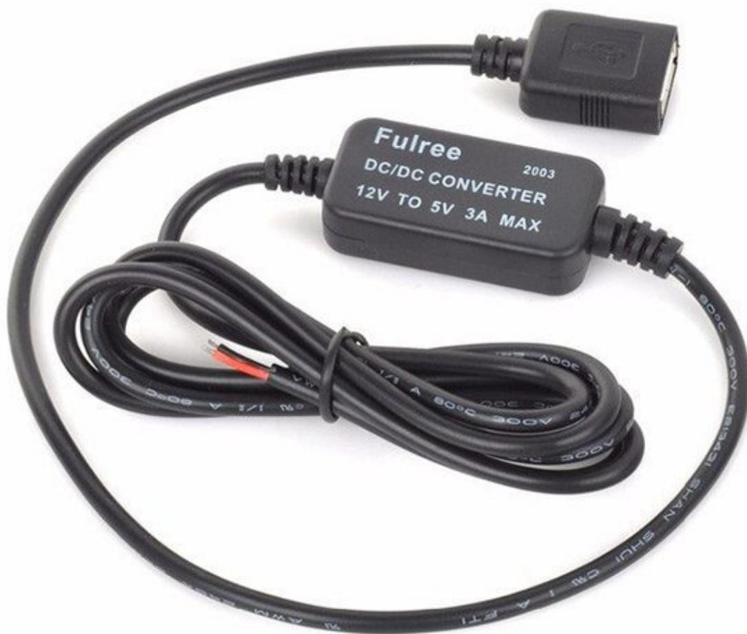
Cavo con convertitore DC/DC stepdown in grado di ridurre una tensione di ingresso da 12 volt a 5 volt in uscita con una corrente max. di 3A. È composto da due terminali a saldare per la tensione di ingresso e da una uscita USB. Lunghezza 1,5 metri.
