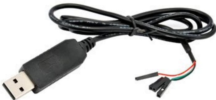
Cavo con convertitore USB-seriale TTL basato sul chip PL2303HX. Dispone di connettore USB tipo A da un lato e 4 fili con connettori singoli dall'altro. La pinout del connettore a 4 pin è: filo rosso Vcc, filo nero GND, verde TXD e bianco RXD. Lunghezza totale: 103 cm.
