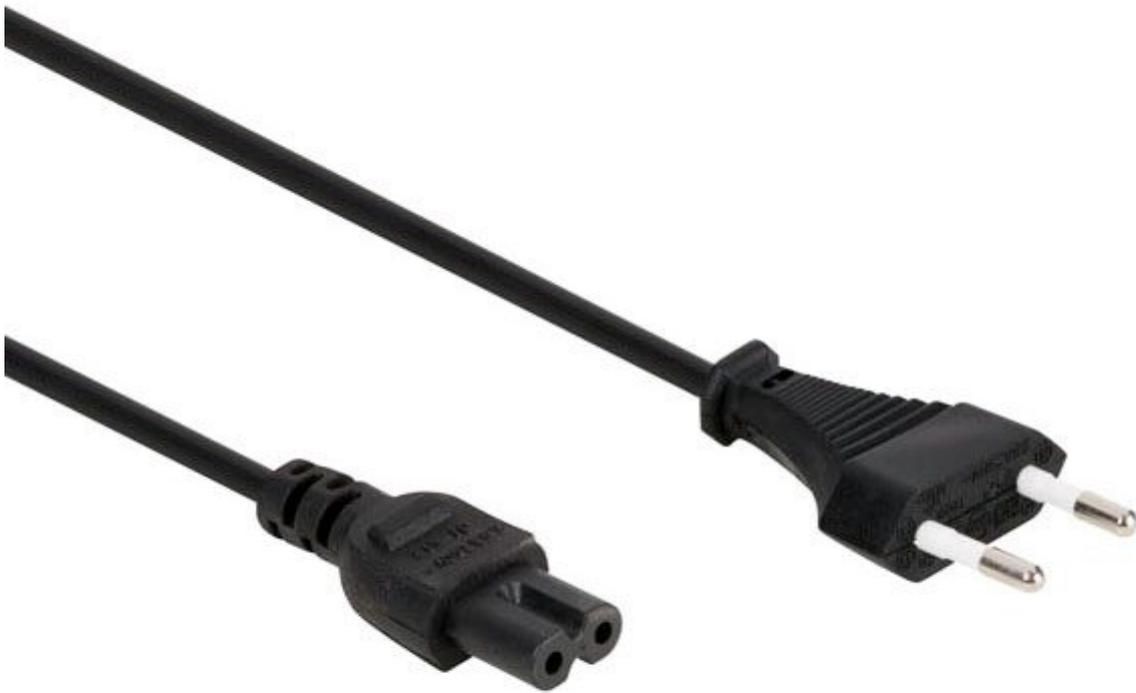
Cavo di alimentazione (H03VVH2-F 2G0.75 mm<sup>2</sup>) 250 Vac con spina CEE 7/16 "Europlug" da un lato e connettore IEC 320-C7 dall'altro. Corrente 2,5 A, lunghezza 2 metri, colore nero.
