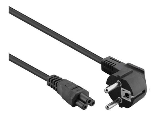
Cavo di alimentazione (H05-VV-F3G-0.75 mm²) 250 Vac con spina SCHUKO (tipo F, CEE 7/7) 90° e presa tipo C5. Corrente 2,5 A, lunghezza 1,8 metri, colore nero.
