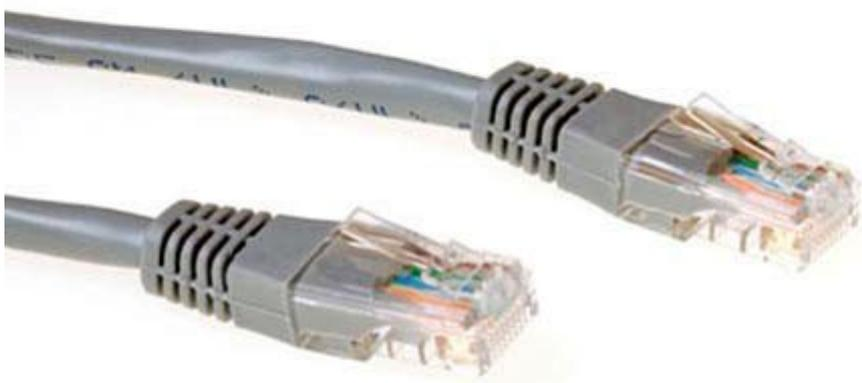
Cavo di rete UTP (Unshielded Twisted Pair) CAT. 5E con banda passante 100 MHz, due connettori RJ45 maschio, AWG26, diametro esterno: 5,4 mm, colore grigio e lunghezza 5 metri.
