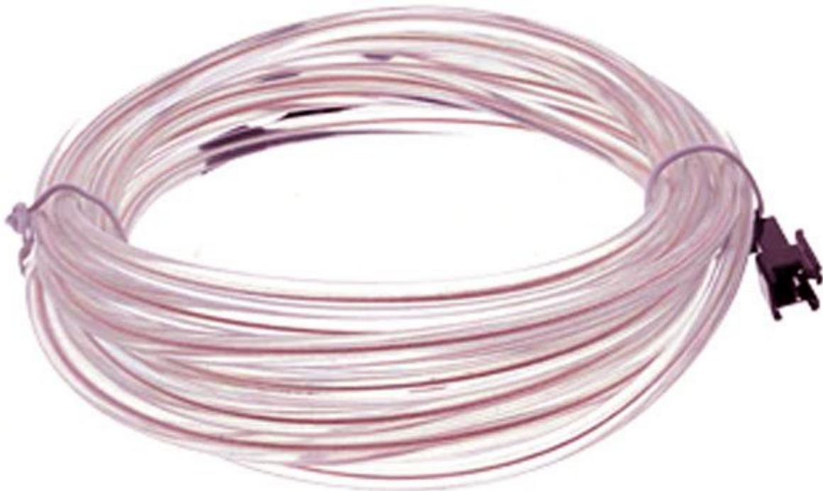
Cavo elettroluminescente molto flessibile di colore bianco lungo 1 metro e con un diametro di 5 mm. Può essere utilizzato in bicicletta, in auto e per decorare qualsiasi ambiente o oggetto. Il cavo termina con un connettore JST e per funzionare necessita di un apposito inverter (non compreso – vedere prodotti correlati).
