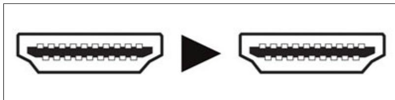
Cavo HDMI maschio/maschio 19 poli, larghezza di banda fino a 10,2 Gbit/s (340 MHz), lunghezza 0,7 metri, colore bianco. Ideale per il collegamento di dispositivi ad alta definizione quali TV HD, ricevitori satellitari, PS3, Xbox, decoder, ecc.
