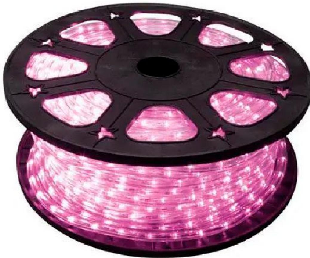
Corda luminosa a led a basso consumo ed elevata durata (circa 50.000 ore). Ideale per realizzare decorazioni luminose statiche. Può essere sezionata in segmenti e impiegata in interno ed esterno grazie alla protezione IP44. Consumo per metro 2,2 W con 36 LED ad alta luminosità. Lunghezza totale 45 metri con 1620 led. Alimentazione 230 VAC. Confezione che comprende cordone di alimentazione e cappuccio terminale di chiusura.
