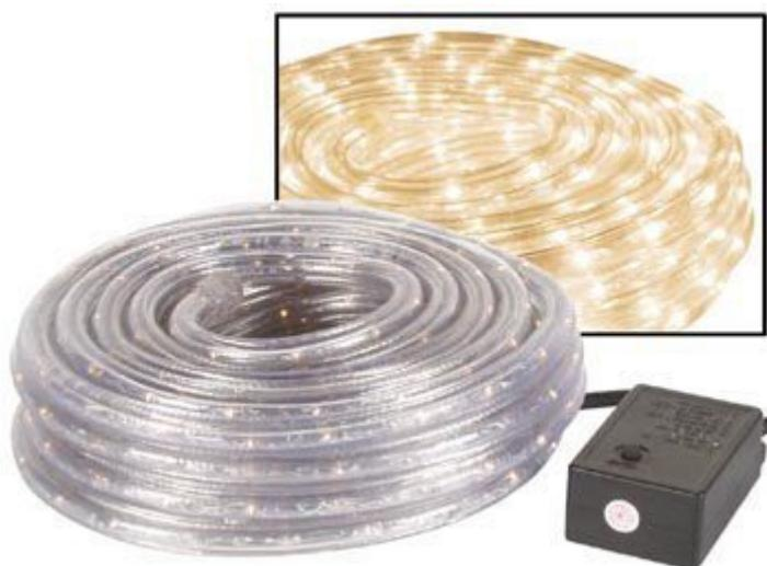
Cavo plastico trasparente e colorato (bianco) nel quale sono inglobate centinaia di minilampadine collegate a due conduttori e ad un box di controllo in grado di generare 8 differenti effetti luminosi. Lunghezza cavo 8 metri, alimentazione 230 Vac. A tenuta stagna per impiego in esterno.
