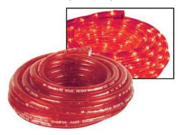
Cavo plastico trasparente e colorato (rosso) nel quale sono inglobate centinaia di minilampadine collegate a due conduttori (anch'essi inglobati) che le alimentano. I due conduttori sono collegati alla tensione di rete a 230 Vac. A tenuta stagna. Il cavo può essere sezionato in più spezzoni. Utilizzabile anche per sistemi di sicurezza. La confezione comprende 9 metri di cavo, un cordone di alimentazione ed una unità di terminazione.
