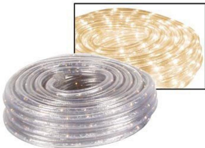
Cavo plastico trasparente nel quale sono inglobate centinaia di minilampadine collegate a due conduttori (anch'essi inglobati) che le alimentano. I due conduttori sono collegati alla tensione di rete a 230 Vac. A tenuta stagna. Il cavo può essere sezionato in più spezzoni. Utilizzabile anche per sistemi di sicurezza. La confezione comprende 9 metri di cavo, un cordone di alimentazione ed una unità di terminazione.
