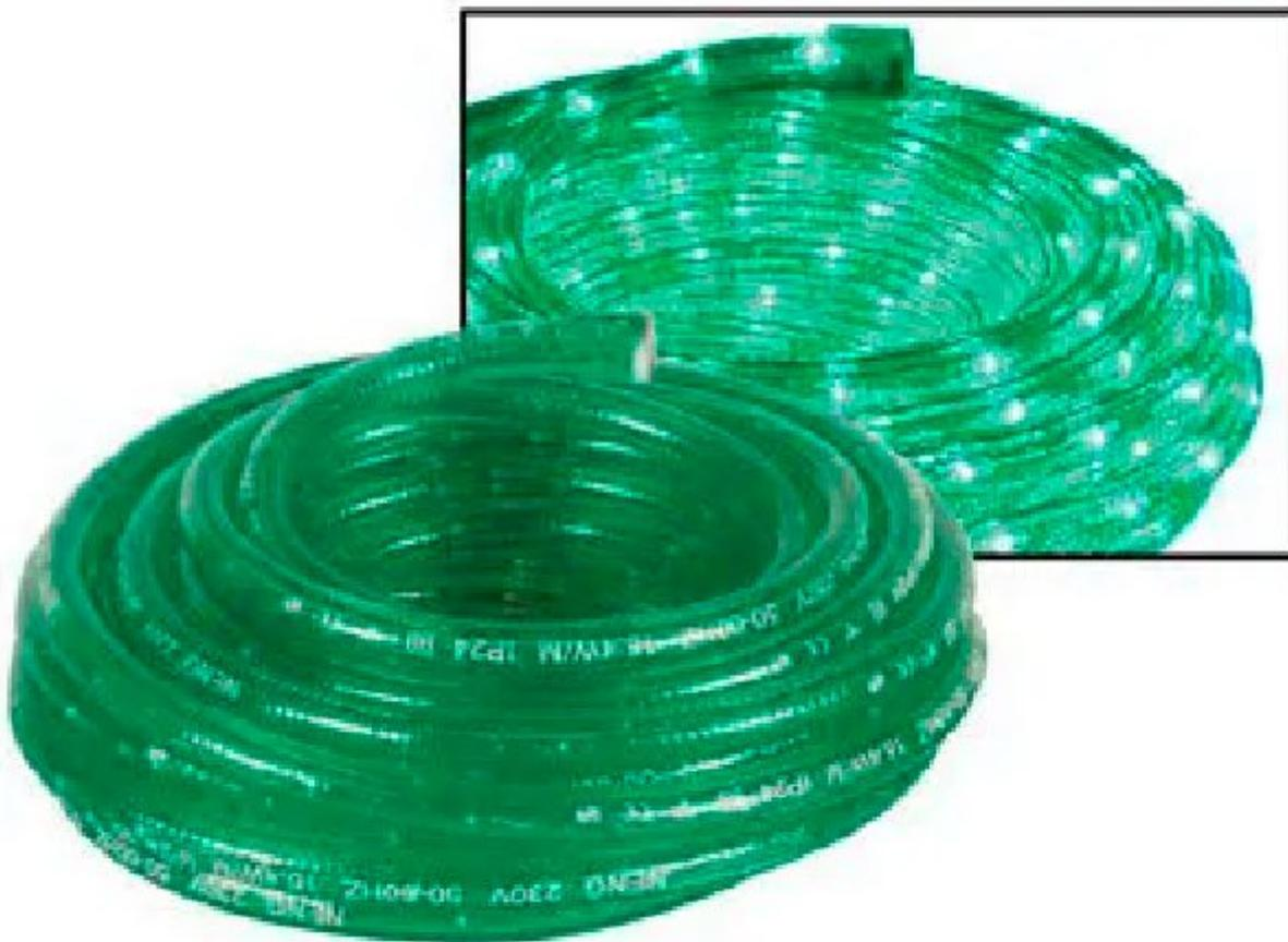
Cavo plastico trasparente e colorato (verde) nel quale sono inglobate centinaia di minilampadine collegate a due conduttori (anch'essi inglobati) che le alimentano. I due conduttori sono collegati alla tensione di rete a 230 Vac. A tenuta stagna. Il cavo può essere sezionato in più spezzoni. Utilizzabile anche per sistemi di sicurezza. La confezione comprende 9 metri di cavo, un cordone di alimentazione ed una unità di terminazione.
