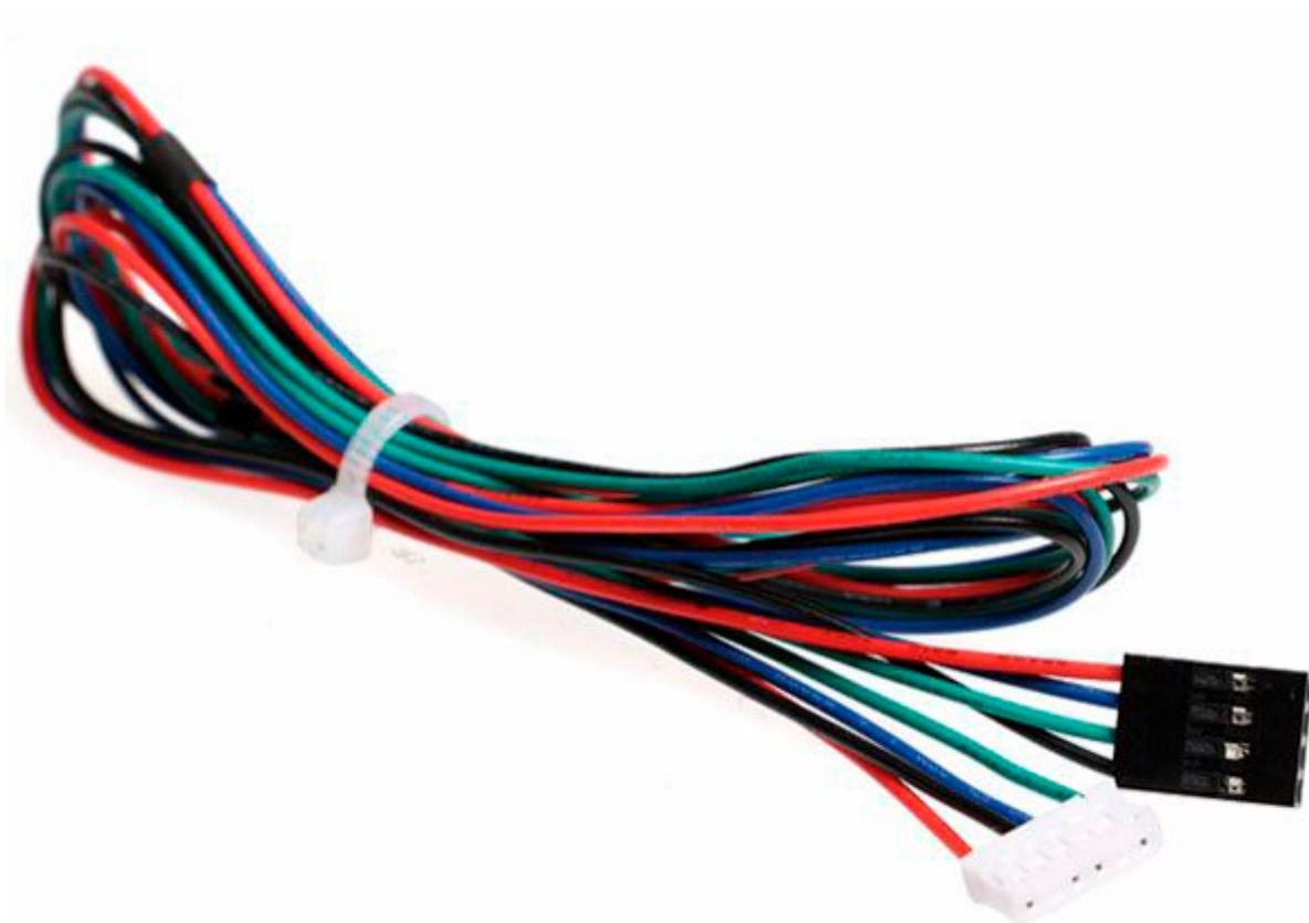
Cavo per motore passo-passo codice STEPMOT03 (non compreso – vedere prodotti correlati). Lungo circa 1 metro (connettori compresi), dispone di connettore standard JST a 6 pin (utilizzati solo 4 pin) da un lato e connettore dupont a 4 pin passo 2,54 mm dall'altro.
