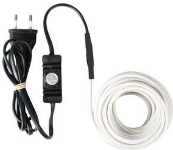
Ideale per prevenire il congelamento di condutture d'acqua, rubinetti e scarichi. Dispone di termostato (non regolabile) che fornisce alimentazione non appena la temperatura scende sotto i 3°C. Il sistema si disattiva quando la temperatura sale al di sopra dei 3°C. Alimentazione 230 Vac (10 W/m); temperatura operativa da -60 a +180°C. Lunghezza: 12 metri.
