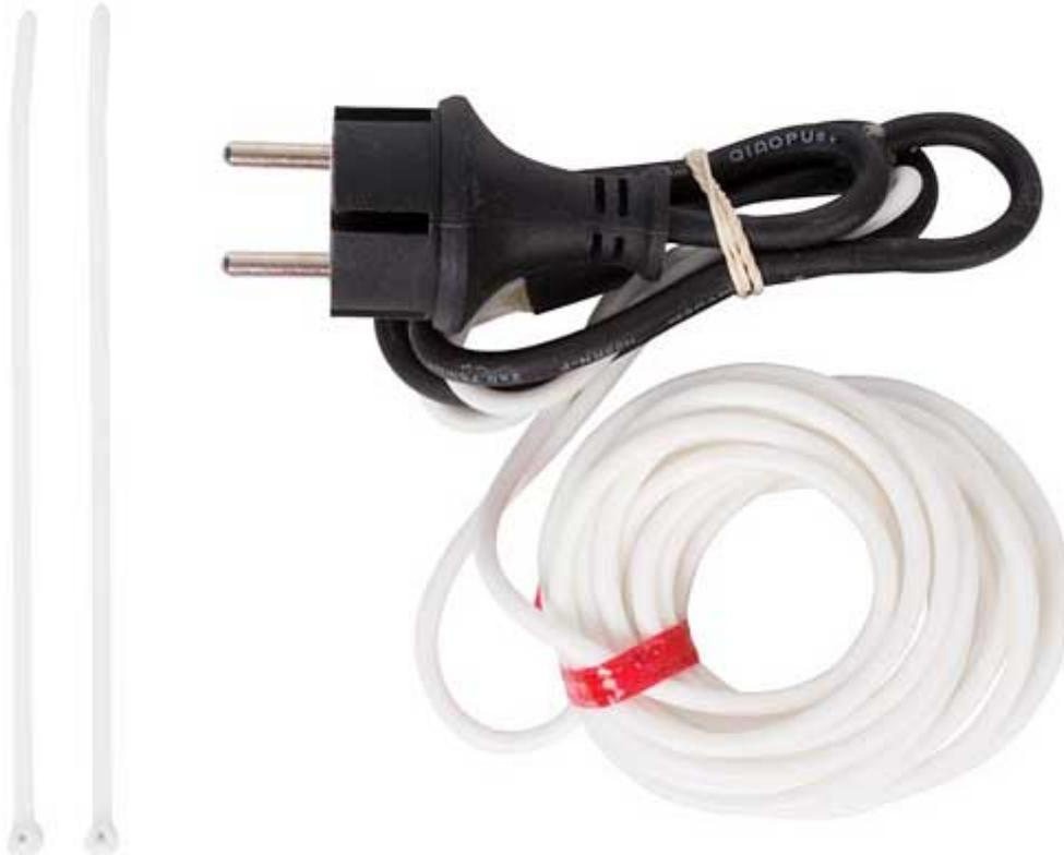
Ideale per prevenire il congelamento di condutture d'acqua, rubinetti e scarichi. Dispone di termostato (non regolabile) che fornisce alimentazione non appena la temperatura scende sotto i 3°C. Il sistema si disattiva quando la temperatura sale al di sopra dei 3°C. Alimentazione 230 Vac (10 W/m); temperatura operativa da -60 a +180°C. Lunghezza: 6 metri.
