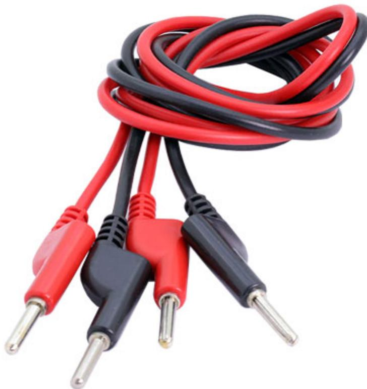
Set composto da 2 cavetti in silicone colorato (rosso e nero) dotati di spinotto a banana da un lato e banana dall'altro. Ciascun spinotto a banana è dotato di una presa posteriore per l'innesto di un'altra spina a banana. Particolarmente adatti per alimentatori, oscilloscopi, generatori di funzioni, ecc. Lunghezza cavi: circa 1 metro, diametro spinotto a Banana: 4 mm.
