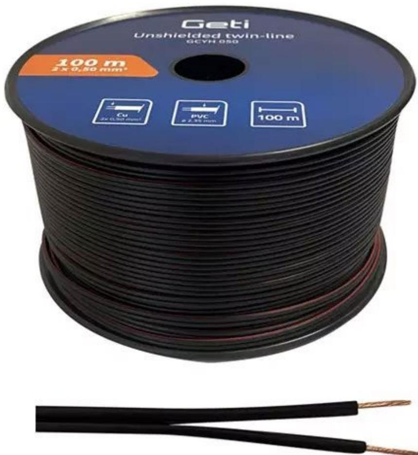
Piattina a due conduttori, uno con isolante di colore nero, l'altro con isolante di colore nero con un filo contrassegnato da una striscia rossa. Sezione del conduttore: 0,5 mm<sup>2</sup>, diametro isolamento esterno (PVC) 2x2,35 mm, materiale conduttore interno: rame (Cu), lunghezza: 100 metri (su matassa), tensione massima di esercizio: 50 volt.
