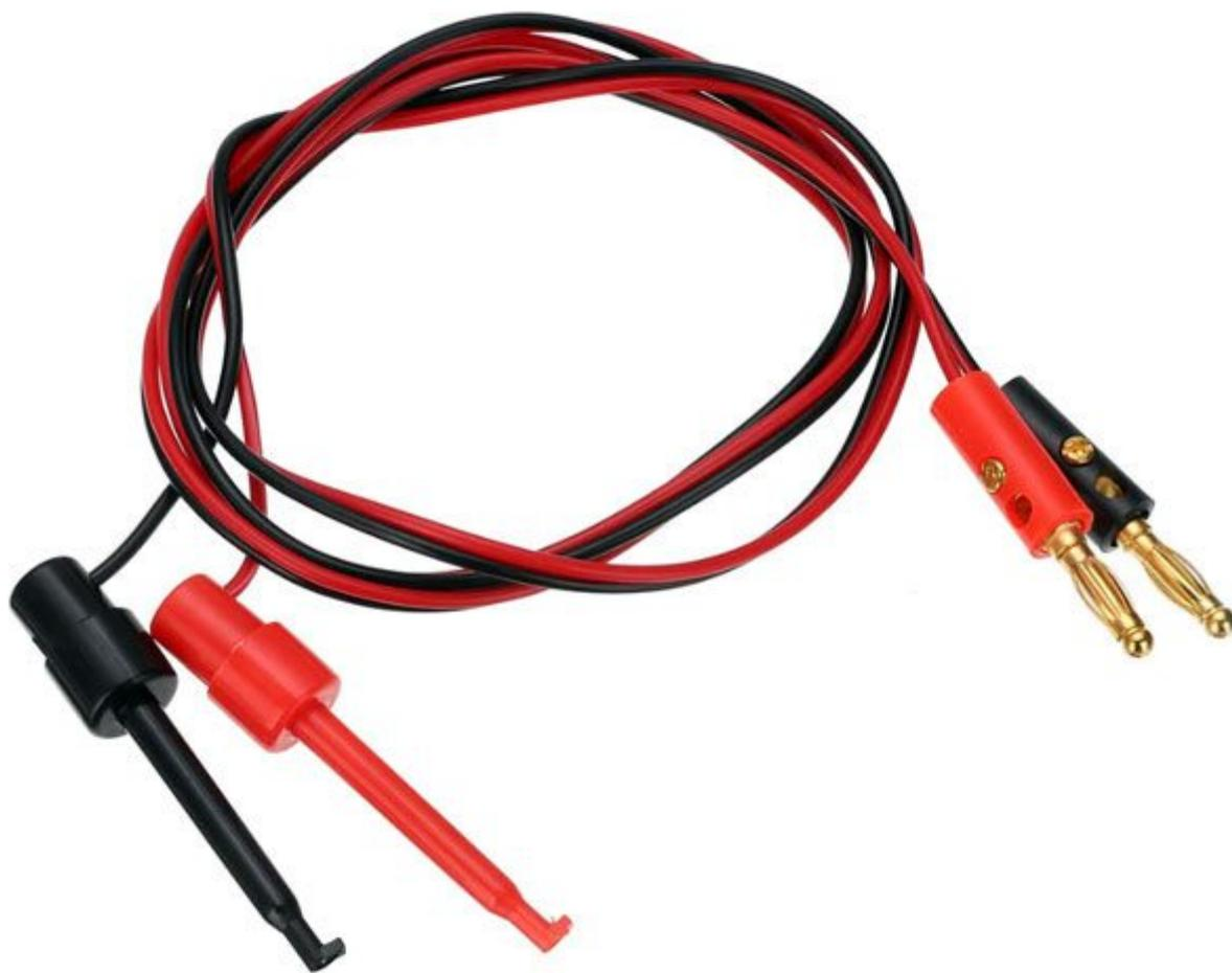
Coppia di cavetti (rosso e nero) dotati di spinotto a banana da 4 mm da un lato e clip per test dall'altro. Ciascun spinotto a banana è dotato di una presa per l'innesto di un'altra spina a banana. Particolarmente adatti per test di laboratorio su schede elettroniche, ecc. Lunghezza totale: circa 90 cm.
