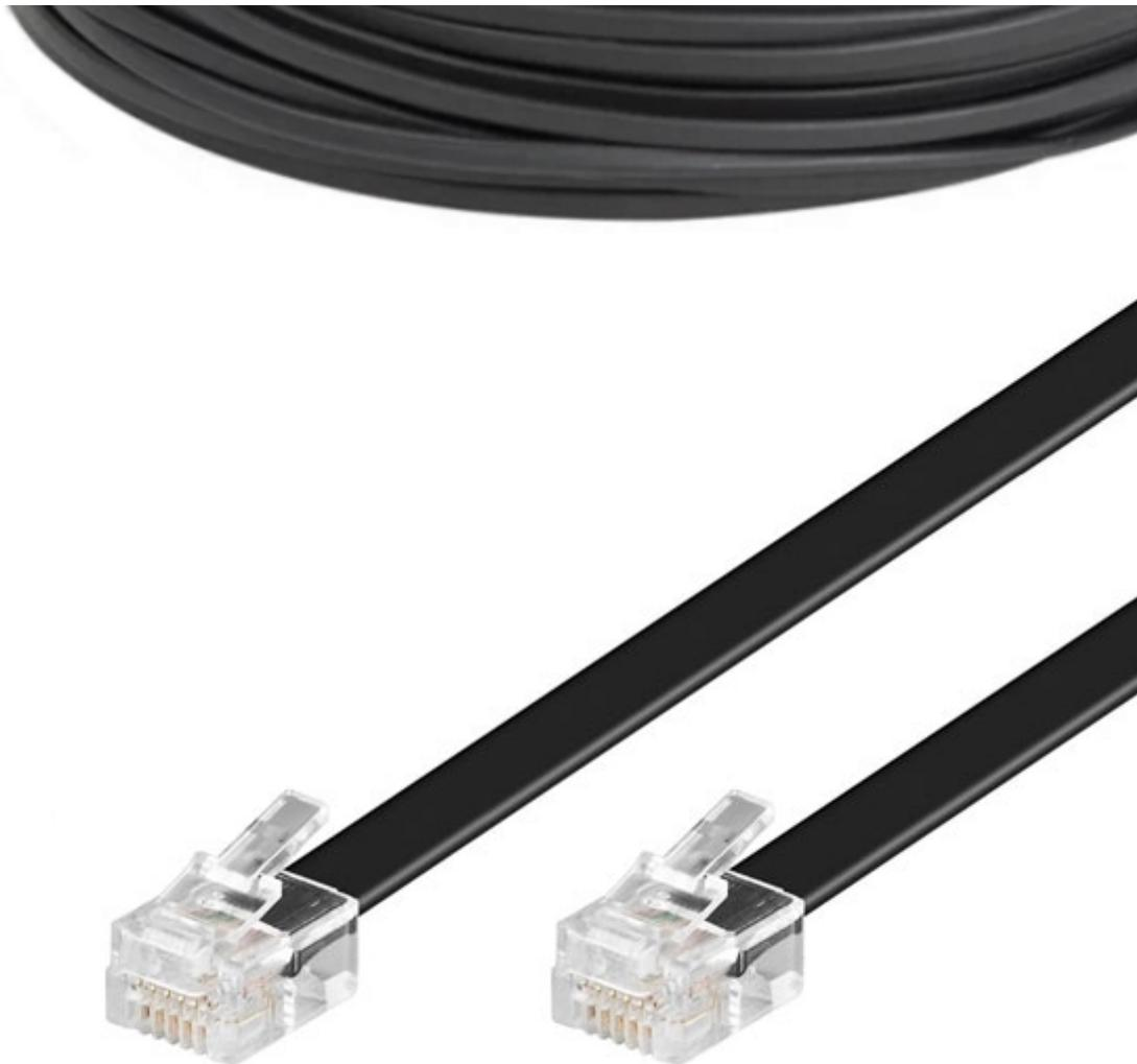
Cavo telefonico con connettore da spina RJ12 (6P6C) a spina RJ12 (6P6C), lunghezza 15 metri. Tipo di cavo: piatto, AWG: 28, colore: nero. Compatibile con molti terminali analogici e digitali come telefono, ISDN, fax, segreteria telefonica (AB), modem, router, sistemi di controllo. Indicato per il collegamento diretto alla presa telefonica (UAE/IAE) o al router (DSL/VDSL) o al sistema PBX.
