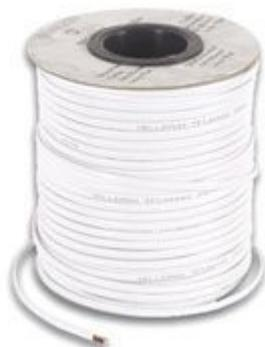
Cavo telefonico piatto 4 conduttori, lunghezza da 100 metri. Colore: bianco, sezione: 4 x 0,08 mm<sup>2</sup>, isolamento: 1mm PVC, conduttore interno: rame nudo 0,12 mm x 7 x 4, dimensioni esterne: 2,55 x 5 mm.
