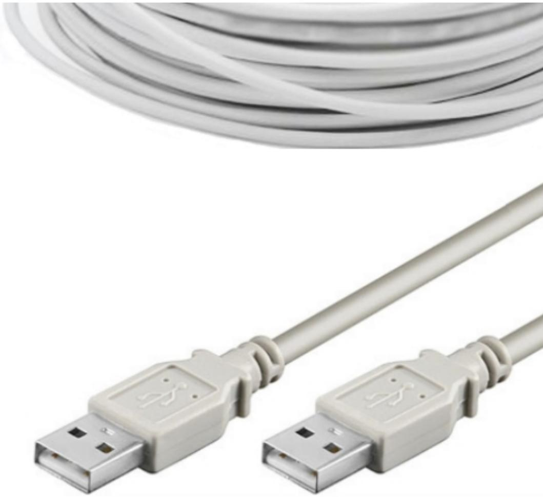
Cavo USB 2.0 con connettore maschio tipo (A) da un lato e connettore maschio tipo (A) dall'altro. Lunghezza: 1,8 m. Tipo di cavo: rotondo, materiale conduttore interno: CU (rame), AWG: 28, numero di schermature: 1, max. velocità di trasmissione: 0,48 Gbit/s.
