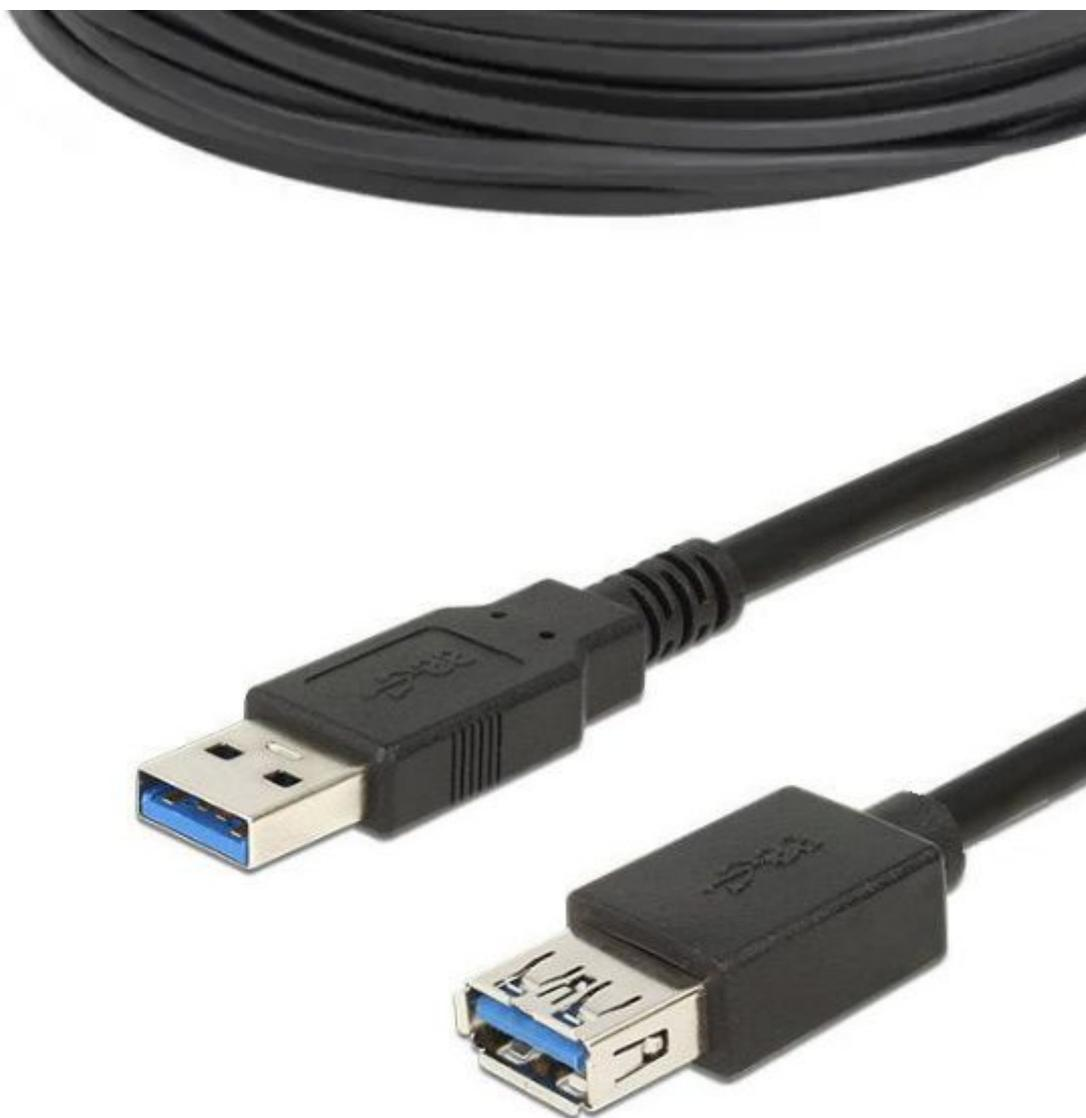
Cavo prolunga USB 3.0 con connettore maschio tipo (A) da un lato e connettore femmina tipo (A) dall'altro. Velocità dati "superspeed" fino a 5 Gbit/s, lunghezza: 1,8 metri.
