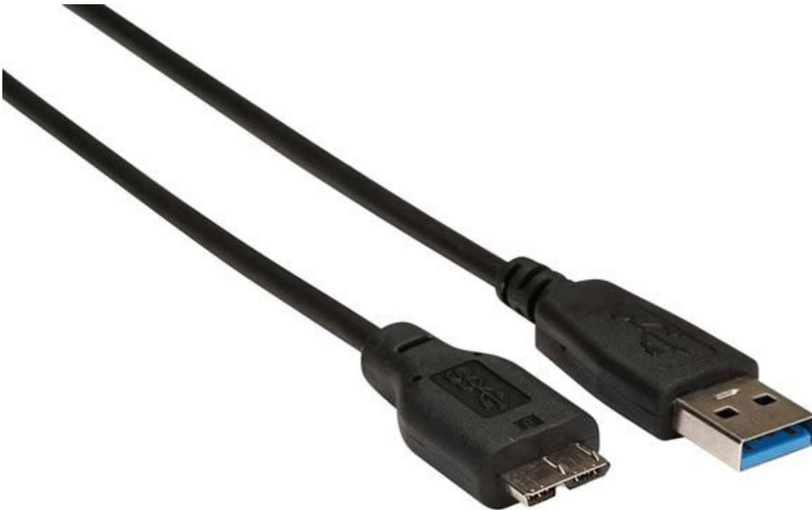
Cavo USB 3.0 con connettore maschio tipo (A) da un lato e micro connettore maschio tipo (B) dall'altro. Lunghezza: 1,8 m, AWG: 24 + 26, diametro esterno: 4.2 mm.
