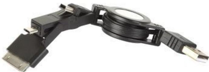
Cavo avvolgibile con connettore USB tipo A da un lato e 3 differenti connettori dall'altro (mini USB, micro USB e connettore per iPad/iPhone/iPod). Lunghezza massima: 80 cm. Peso: 25 grammi. Standard USB 2.0. Tensione massima 5V / 2100 mA.
