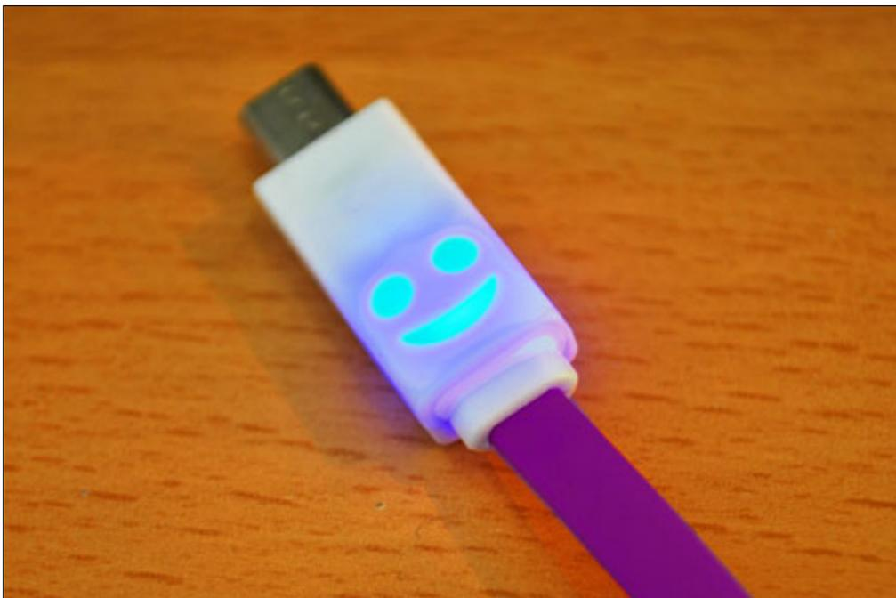
Originale cavo USB A maschio-micro USB realizzato in TPE e dotato di faccina smile (da entrambi i lati del connettore) che si illumina non appena viene inserito nella porta USB del PC. Compatibile con: Samsung, Blackberry, HTC, Nokia, LG, Sony, Motorola e altri dispositivi dotati di connettore micro USB, colore: viola, lunghezza 1 metro. **N.B.** il connettore USB A non ha verso di inserzione.
