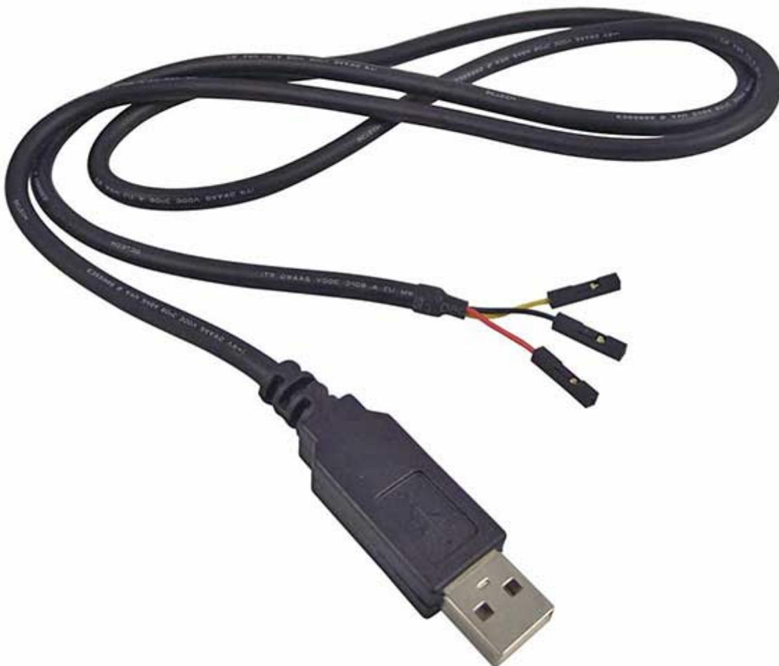
Questo cavo USB to UART fornisce un percorso di trasferimento dati seriale asincrono tramite USB, capace di supportare velocità di trasmissione dati da 300 bit/s a 3 Mbit/s a livelli TTL di 3,3 V. Il chip gestisce tutti i requisiti di segnalazione e protocollo USB, permettendo un ambiente di debug e sviluppo migliorato, dove è possibile accedere ai messaggi di debug del kernel.
