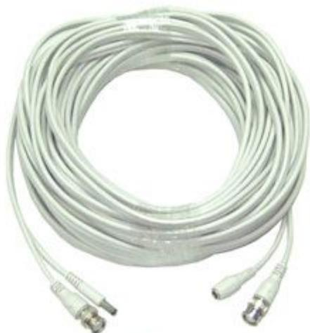
Cavo video dotato da un lato di connettore BNC maschio e presa di alimentazione (2,1 x 5,5 mm), dall'altro di connettore BNC maschio e spina di alimentazione (2,1 x 5,5 mm). Lunghezza 10 metri. Tipo di cavo: 22AWG, diametro: 4,3 mm.
