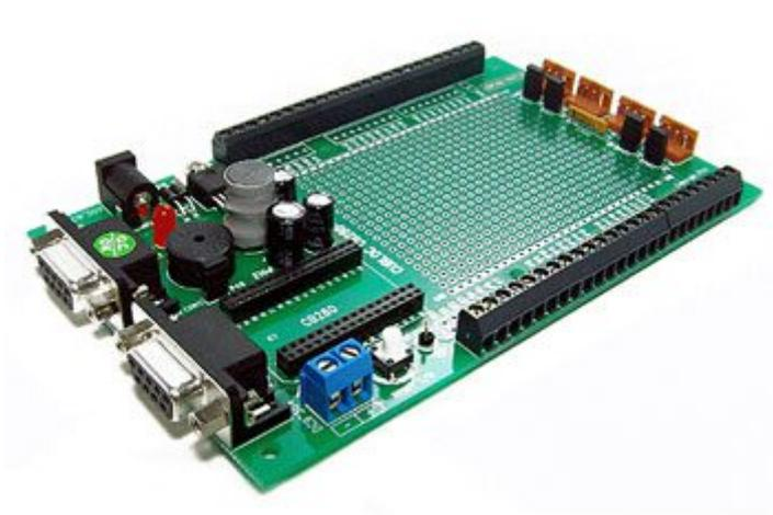
Piastra sperimentale che permette di testare le applicazioni scritte per il modulo CUBLOC CB280 e CB380 senza dover realizzare un apposito circuito stampato. La scheda è provvista della sezione di alimentazione, di due connettori DB9 necessari per la programmazione del modulo CUBLOC CB280/CB380 e una sezione sperimentale per realizzare piccole connessioni. Attacco per guida DIN. Dimensioni 155 x 88 x 28 mm.
