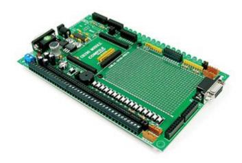
Piastra sperimentale tramite la quale è possibile testare le proprie applicazioni basate sul modulo CUBLOC CB290 senza dover realizzare un apposito circuito stampato. La scheda è provvista della sezione di alimentazione, 16 LED, 16 pulsanti, 1 buzzer, due connettori DB9 necessari per la programmazione del modulo CUBLOC CB290 e una sezione sperimentale per realizzare le connessioni necessarie. Attacco per guida DIN. Dimensioni 220 x 110 x 28 mm.
