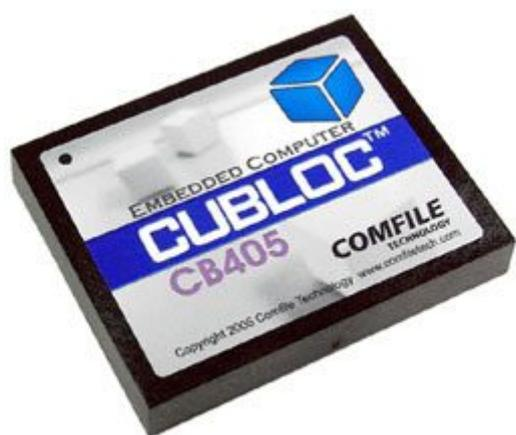
Modulo CB405 in case a 80 pin, basato sul microcontrollore Atmel Atmega2560, utilizza come linguaggio di programmazione il Basic e la logica Ladder (Multi-tasking). Il Cubloc CB405 è dotato di una memoria programma Flash da 200 kB, una EEprom da 4 kB, 64 I/O configurabili e una velocità di esecuzione di 36.000 istruzioni al secondo. La scheda QSB1000 (QUICK START BOARD 1000) è appositamente studiata per la programmazione di questo modulo.
