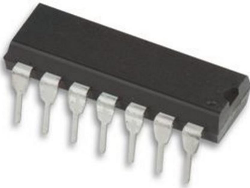
CD4066 integrato della famiglia Cmos - quadruplo commutatore bilaterale - DIP14.
