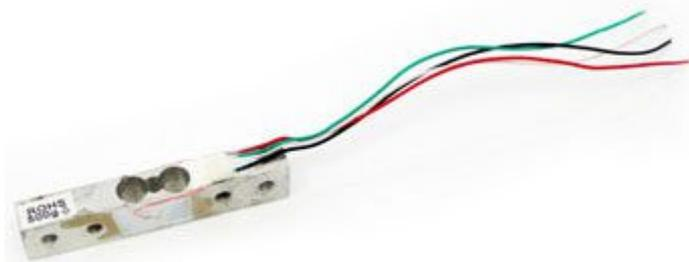
Cella di carico composta da una struttura in metallo e da piccoli elementi chiamati estensimetri (strain gauges) montati in precisi punti sulla struttura. Fornisce in uscita un segnale elettrico che varia in funzione della deformazione che la forza applicata sul componente produce. Le applicazioni più comuni sono: bilance elettroniche, contapezzi, bilance per pacchetti postali e tutte le varietà di bilance commerciali a singola cella.
