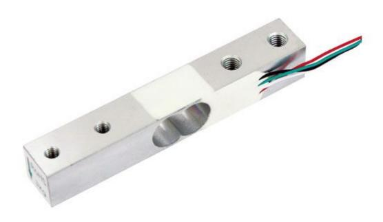
Cella di carico composta da una struttura in metallo e da piccoli elementi chiamati estensimetri (strain gauges) montati in precisi punti sulla struttura. Fornisce in uscita un segnale elettrico che varia in funzione della deformazione che la forza applicata sul componente produce. Le applicazioni più comuni sono: bilance elettroniche, contapezzi, bilance per pacchetti postali e tutte le varietà di bilance commerciali a singola cella.
