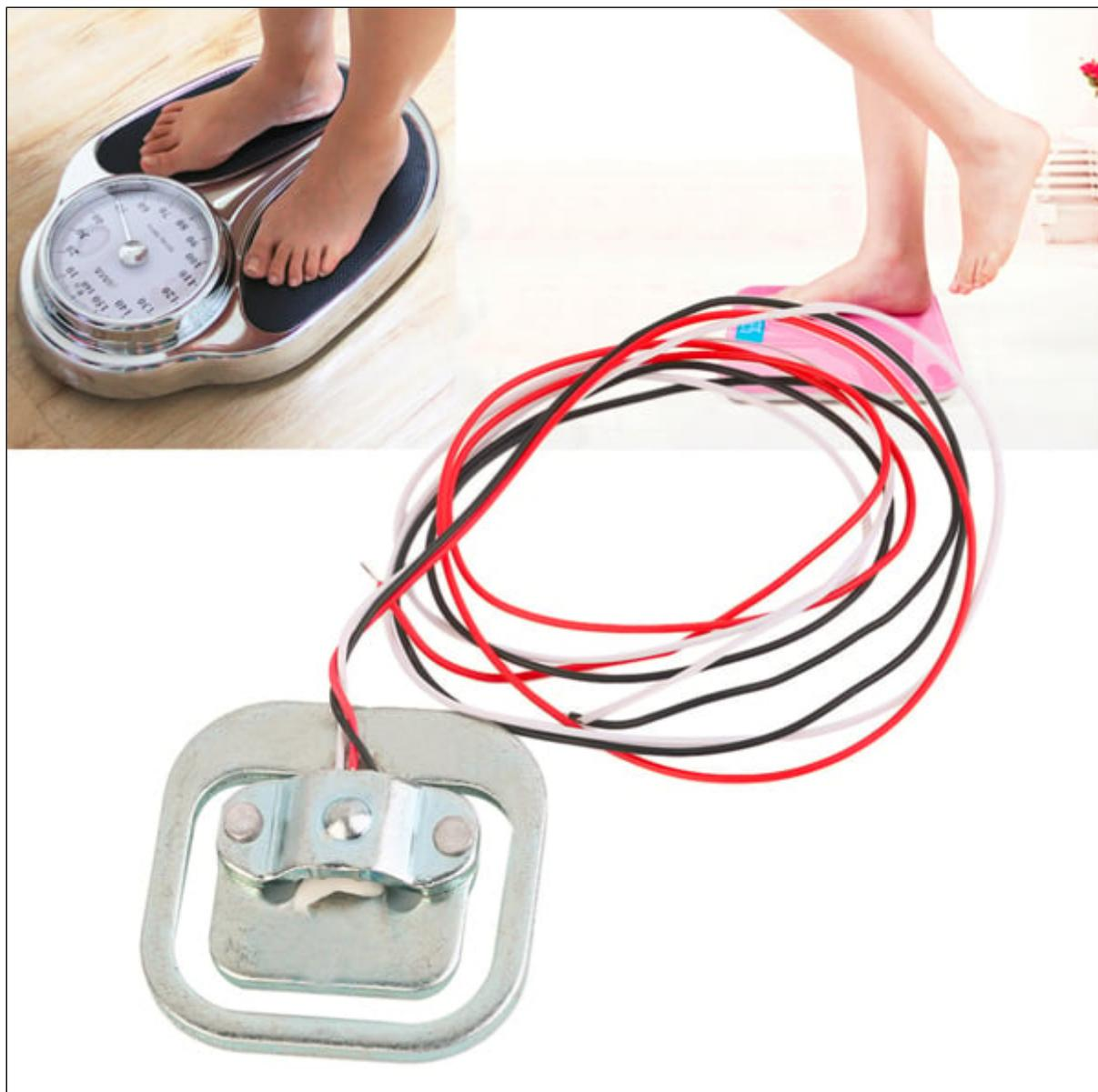
Cella di carico composta da una struttura in metallo e da piccoli elementi chiamati estensimetri (strain gauges) montati in precisi punti sulla struttura. Fornisce in uscita un segnale elettrico che varia in funzione della deformazione che la forza, applicata sul componente, produce. Le applicazioni più comuni sono: bilance elettroniche, contapezzi, bilance per pacchetti postali e tutte le varietà di bilance commerciali a singola cella.
