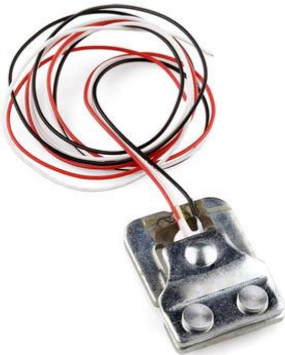
Cella di carico composta da una struttura in metallo e da piccoli elementi chiamati estensimetri (strain gauges) montati in precisi punti sulla struttura. Fornisce in uscita un segnale elettrico che varia in funzione della deformazione che la forza applicata sul componente produce. Le applicazioni più comuni sono: bilance elettroniche, contapezzi, bilance per pacchetti postali e tutte le varietà di bilance commerciali a singola cella.
