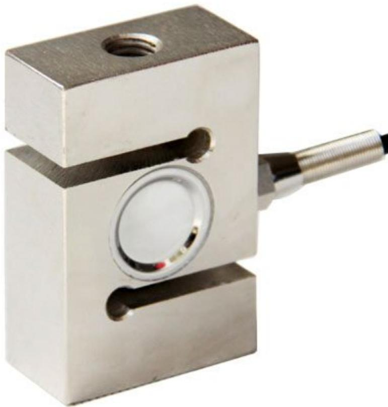
Cella di carico di tipo "S" realizzata in acciaio inossidabile, classe di precisione C3, range 200 kg e due fori filetati M12. È in grado di misurare la deformazione che la forza (trazione o compressione) applicata sul componente produce. Le applicazioni più comuni sono:
