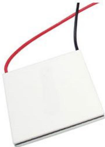
Cella di PELTIER 51W a 12 volt. Corrente massima assorbita di 6,4 ampère. Differenziale massimo fra le temperature lato caldo e lato freddo di 68 °C. Tensione massima di alimentazione 14,9 volt. Potenza frigorifera massima di 51 watt con temperatura sul lato caldo stabilizzata a 27 °C. Peso 27 grammi. Ore di funzionamento: circa 200.000 ore.
