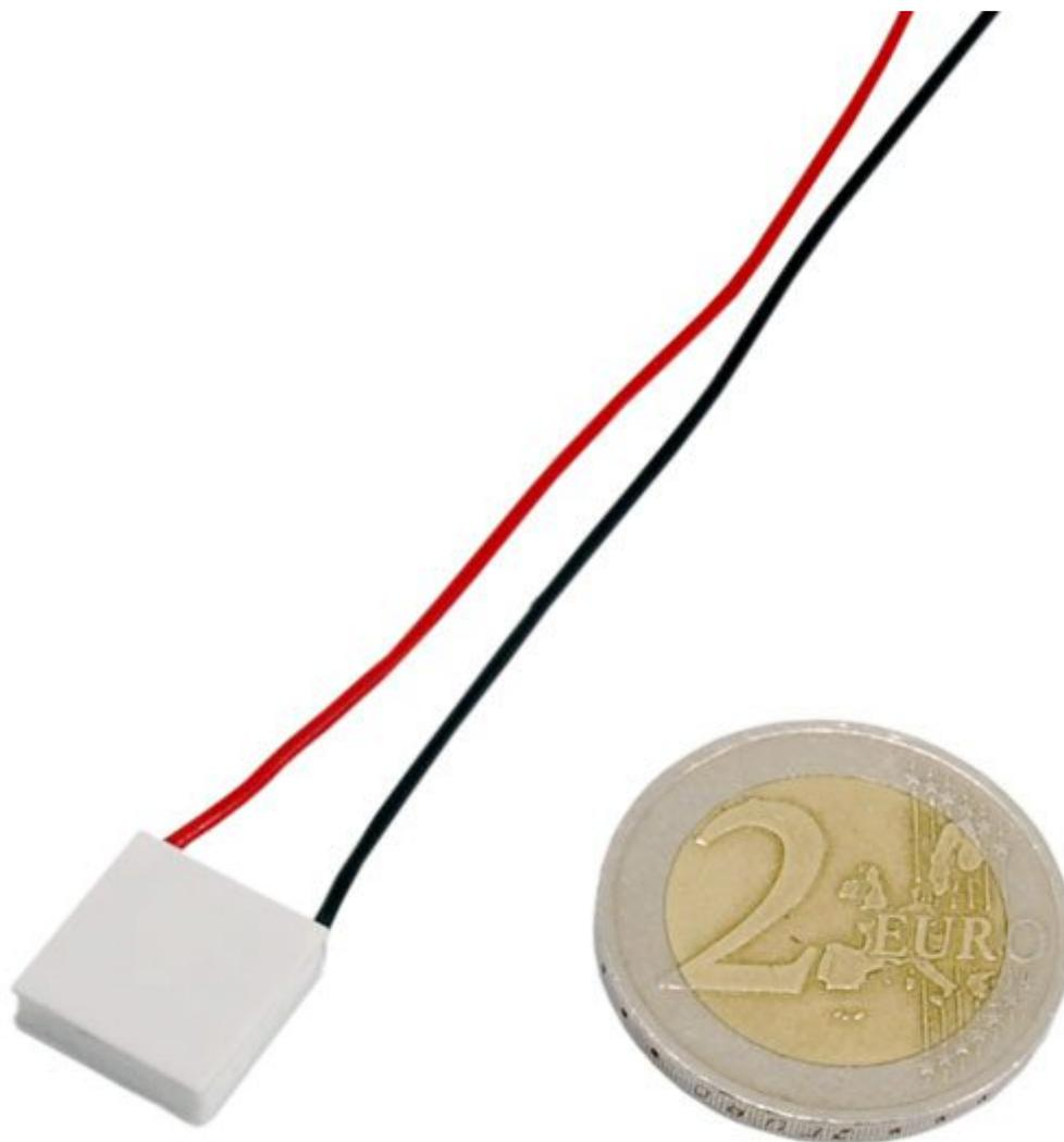
Cella di PELTIER 5,2 W a 4 volt. Corrente massima assorbita di 2,1 amper. Differenziale massimo fra le temperature lato caldo e lato freddo di 70°C. Tensione massima di alimentazione 4,2 volt. Potenza frigorifera massima di 5,2 watt con temperatura sul lato caldo stabilizzata a 27°C. Dimensioni (mm )12x12x3,7, lunghezza fili 125 mm, peso: 2 grammi. Ore di funzionamento: circa 200.000 ore.
